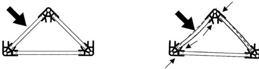
Fig. 26 - Kracht uitgeoefend op de zijkant van een driehoek.
