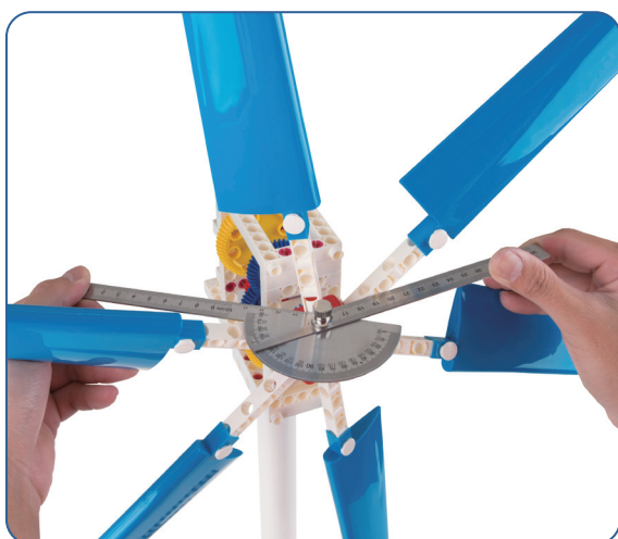
Fig. 48 Stel de hoek in met behulp van een hoekmeter (noteer de hoekinstellingen – aantal graden - op een onderliggend papier)
